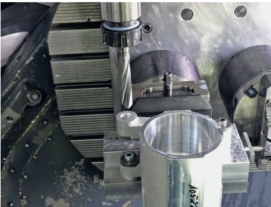
1 Unter anderem beim Erzeugen von H8-Bohrungen in AlMgSi7 spielen Bison.C-beschichtete VHM-Bohrer bei der ktc GmbH ihre Stärken aus © Technisches F&E-Zentrum
